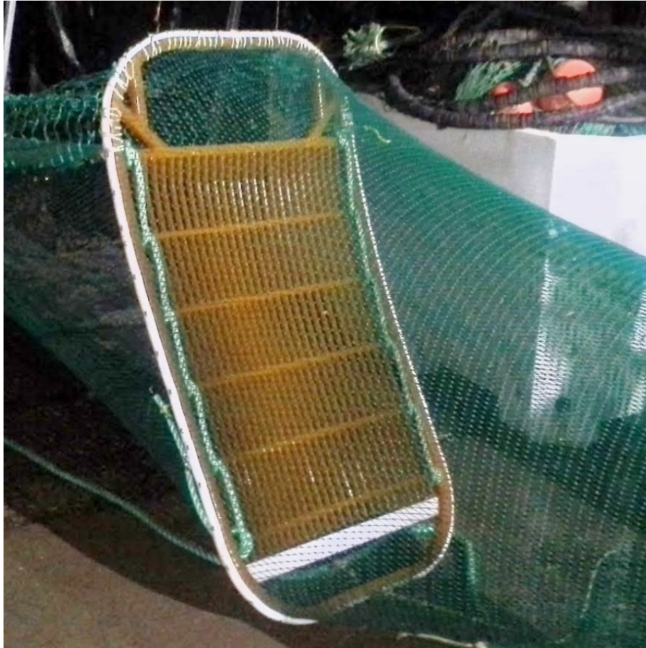
Figur 1. Krepsehullet i nedkant av rekerista. Når det hvite tverr-staget er montert, er spaltehøyden 10 cm, og når det er fjernet er den 15 cm. Øverst er fiskeutslippshullet, og til venstre for dette skimtes det stor-maskede seleksjons-panelet.
